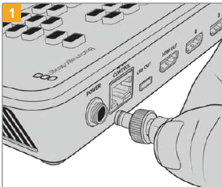
1 Conecte el mezclador a la red de suministro eléctrico mediante el cable provisto.
