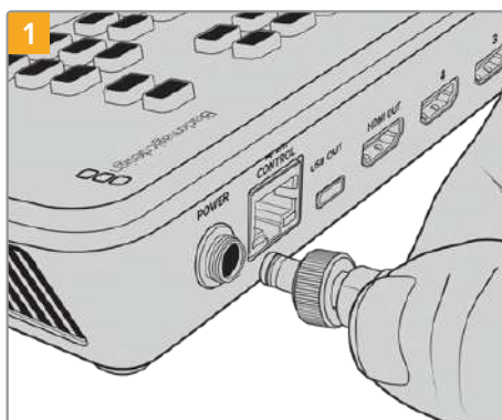
Collega ATEM Mini alla corrente con l'adattatore in dotazione
